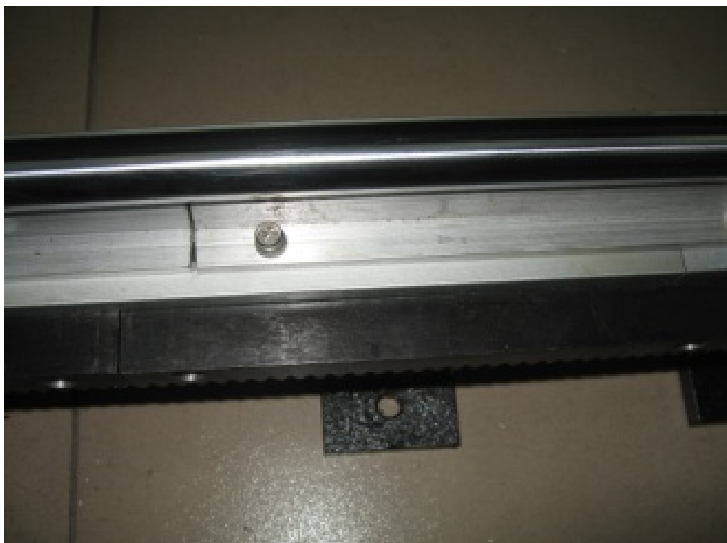
Рис.5. После сборки затянуть крепежные болты.
